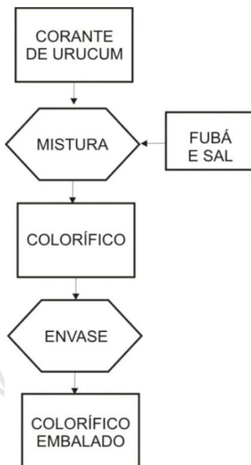
FIGURA 3. Fluxograma de produção de colorífico pelo processo que usa o corante de urucum.
